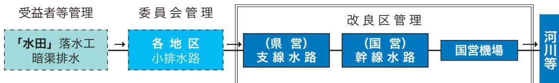
排水は、水田から落水工及び暗渠排水により小排水路に流下させ、支線排水路・幹線排水路を経由し、遊水地(吸水槽)に集まり溜まった水を排水機場よりポンプアップして一級河川等に排水しています。
