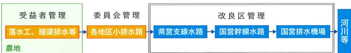
排水は、水田から落水工及び暗渠排水により小排水路に流下させ支線排水路・幹線排水路を経由して、遊水池に集り溜まった水を、排水機場によりポンプアップして一級河川等に排水しております。
